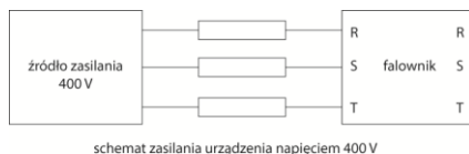
Doładowanie kondensatorów przez rezystory ograniczające
